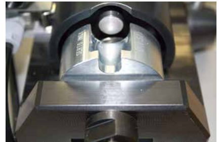
drehbare Werkzeugtrommel mit bis zu 5 Grössen
